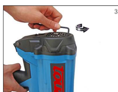
Используйте отвертку или гвозди чтобы приподнять крышку
