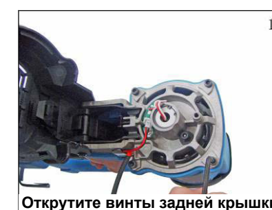
Используйте отвертку или гвозди чтобы приподнять крышку
