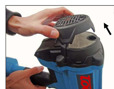
Используйте отвертку или гвозди чтобы приподнять крышку
