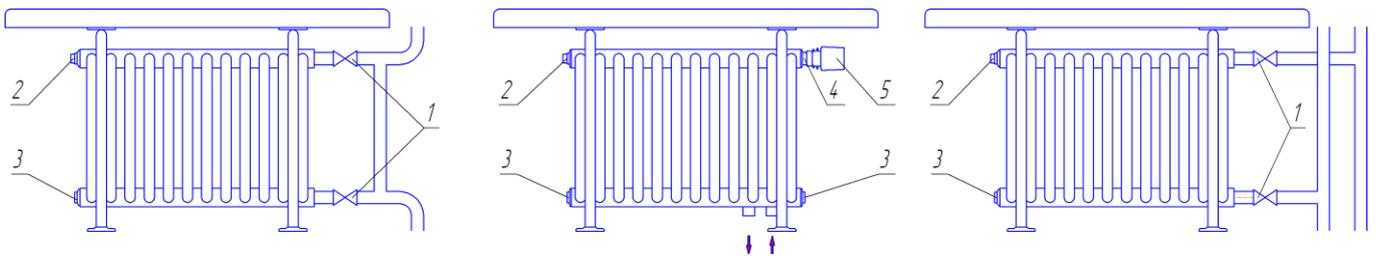
1. Вентиль. 2. Кран-воздухоотводчик. 3. Пробка глухая. 4. Клапан терморегулятора. 5. Термостатический элемент.
